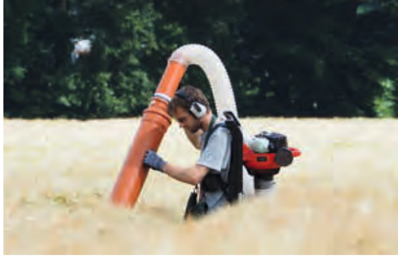
Erhebung der Insektenverfügbarkeit mithilfe eines Insektensaugers
